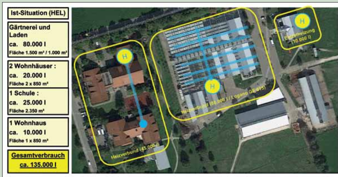
Kastanienhof Bodelshausen: Bestand Heizsystem (Quelle: Neth 2014)
